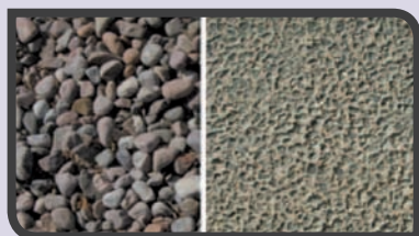
► Gravillons et béton lavés
