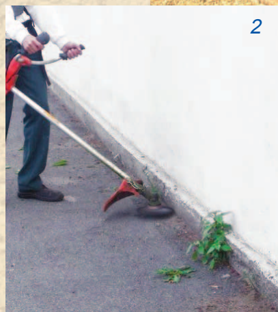
1 - Balayeuse portée 2 - Brosse sur débroussailleuse 3 - Brosse individuelle
